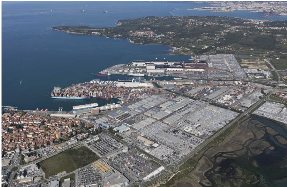
3. kép: A hajóbeálló helyek mögötti kiszolgáló szuperstruktúra (raktárok, tartályok, lerakóhelyek, üzemi épületek) és közlekedési infrastruktúra (utak, iparvágányok) a koperi kikötőben
